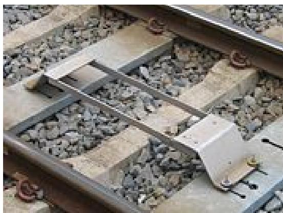
Figure 20 Balise de connexion entre le rail et le TGV
