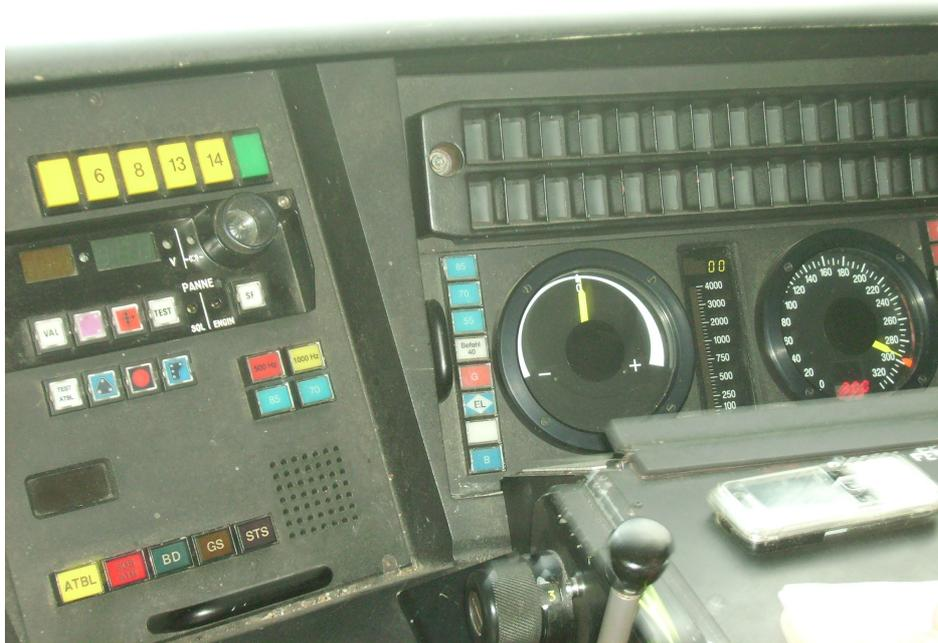
**Figure 27 le tachymètre du poste de pilotage Thalys**
